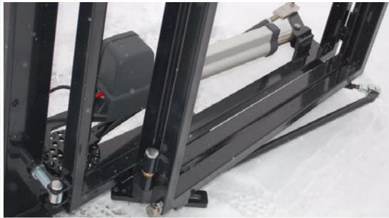
Abbildung 21: Faltechnik bei geöffneter Flügelstellung
