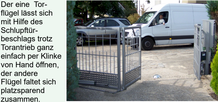
Abbildung 11: Schlupftürflügel bei Handbetätigung
