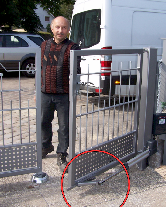
Abbildung 11: Schlupftürflügel bei Handbetätigung
