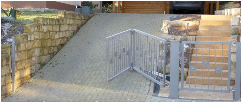
Abbildung 10: stark ansteigende Einfahrt, Faltflügel beim Öffnungsvorgang
