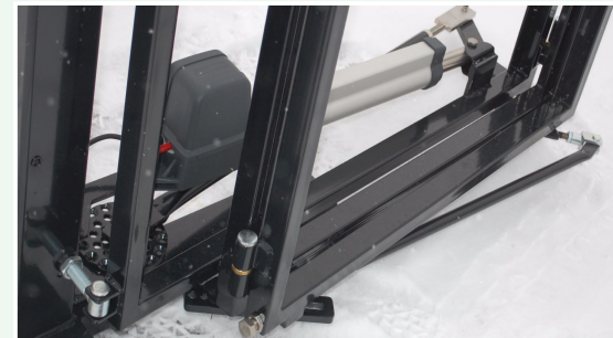
Abbildung 21: Faltmechanik bei geöffneter Flügelstellung
